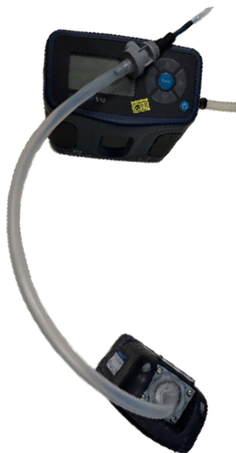
Obrázek 3. Vzorkovací pumpa s trubičkou.
