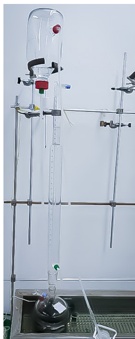
Obrázek 2: Eudiometrická aparatura pro stanovení celkové produkce plynu GS21
