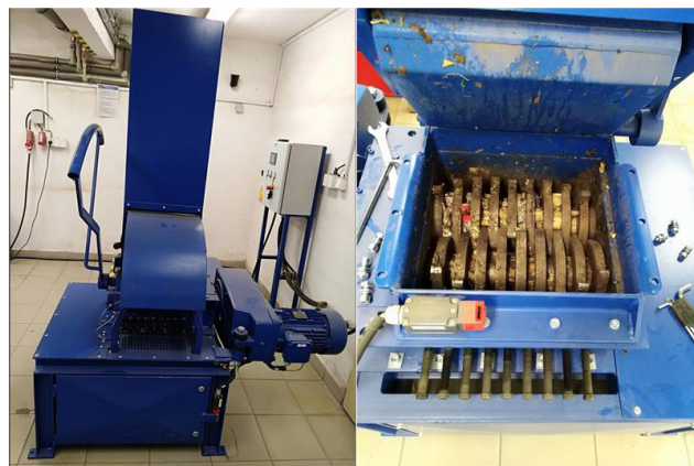
Obrázek 3: Homogenizace vzorků pomocí válcového mlýnu
